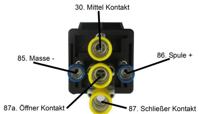
Die Flachsteckhülsen blau sind für einen Kabelquerschnitt von 1,5 bis 2,5 mm<sup>2</sup> und die Flachsteckhülsen gelb für einen Kabelquerschnitt von 4,0 bis 6,0 mm<sup>2</sup> ausgelegt.
